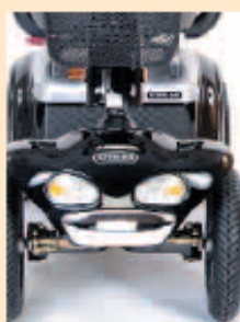
Conjunto de luces e indicadores
