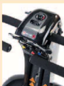
Doble acelerador para presionar con la mano o un solo dedo
